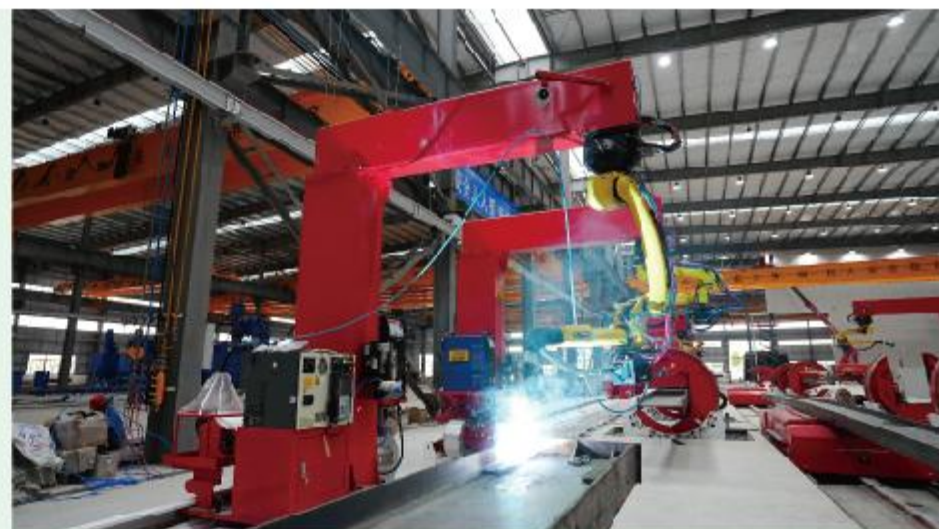
车间RGV小车高效输送工件，机械臂精准焊接
